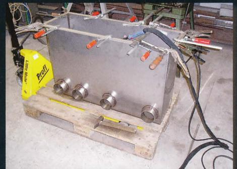
33 Die Sammelkammer mit integrierten Halterungen zur Aufnahme der UVC-Tauchstrahler.
