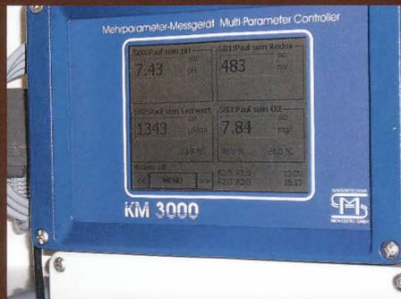
39 Ein Mehrparameter-Messgerät mit GSM-Modul wird in Betrieb genommen.
